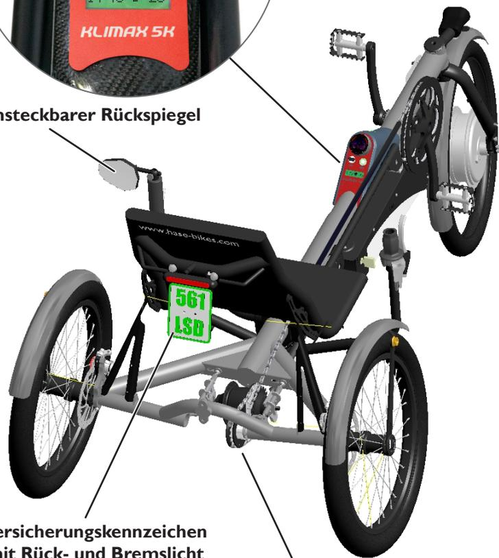
Versicherungskennzeichen mit Rück- und Bremslicht
